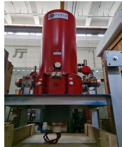
Klystron • 500 kW • >1000 s
